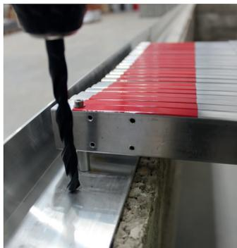
Retirez les boulons à ressort si la goupille de positionnement verticale est requise.
