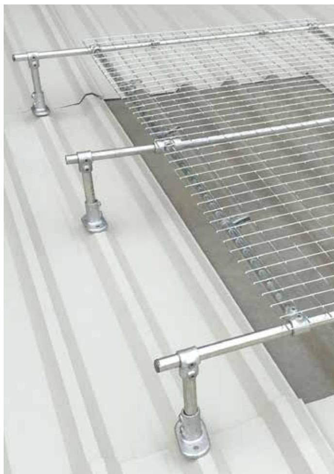
Le système **KEE COVER** a été spécialement conçu pour les toitures à profil métallique pourvues de nombreux translucides. La grille est montée sur un cadre métallique composé de raccords **KEE KLAMP** et de tubes de taille 5 (diamètre extérieur de 26,9 mm). Les grilles standards font 2 m de long par 1 m de large. Des extensions de 2 m ou 1 m de long par 1 m de large sont disponibles.
