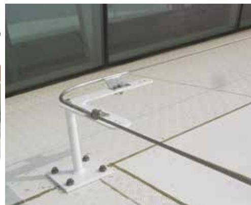
Créée par Kee Safety, la gamme **POSTANKA** d'ancrages mécanosoudés galvanisés à chaud a été conçue à l'aide d'un programme de calculs standard, conformément aux exigences de la Classe A2 de la norme EN795 ou aux exigences de l'OSHA (résistance de 5 000 lb - 22,2 kN).
